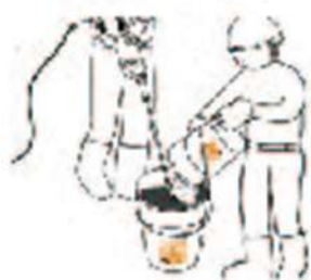
先ほど混ぜた粉末のバケツを 液体のバケツの中に入れます
